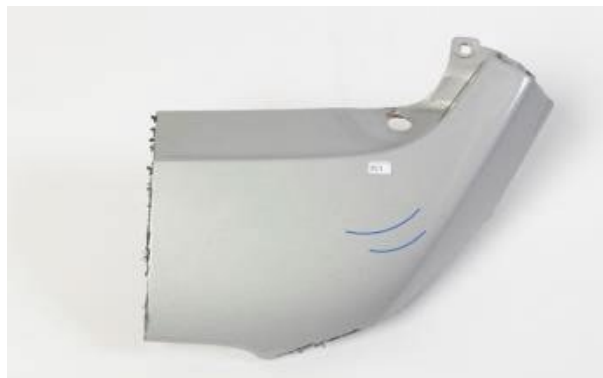
Pd2: Plastdetalj förlackerad med silver metallic Volvo 711 och klarlack. Förproducerad skrapkada.
